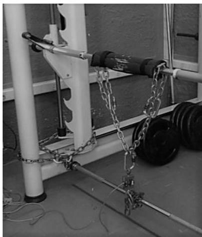
**Figura 2.** Imagen de la fijación de la celda de carga y de las corrientes para fijación de la barra.
